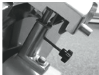
3. Fissare il dispositivo di affilatura alla macchina serrando il supporto. Accertarsi che il dispositivo di affilatura sia saldamente fissato prima di utilizzare la macchina.
