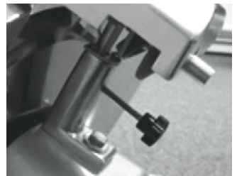
3. Borg de slijpvoorziening aan de machine door de borging aan te draaien. Controleer of de slijpvoorziening vast zit voordat u de machine in gebruik neemt.
