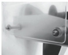
3. Inserire le due rondelle sui bulloni.
