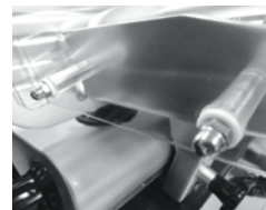
4. Nakręć dwie nakrętki kotłakowe.
